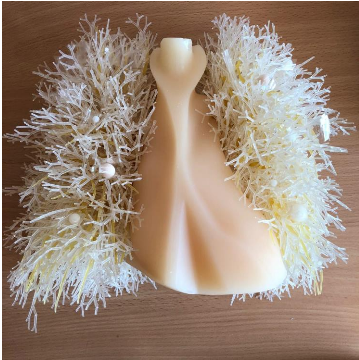
Рисунок 1 – Тест-объект для определения очагов различных размеров и плотности, помещенных в фантом
