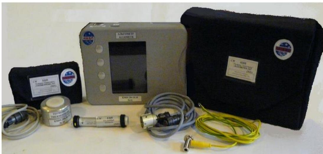
Рисунок 2 – Комплект «Тензо-термоальгометр» (ТТА)
