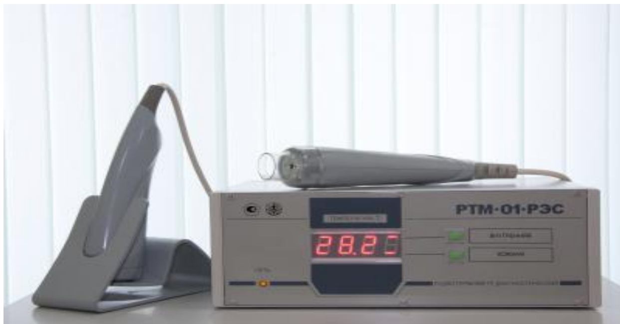
Рис. 2. Неинвазивный СВЧ-термометр PTM-01-РЭС
