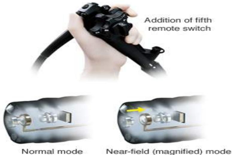
Рис. 6. Схематичное устройство увеличительного (Zoom) эндоскопа.
