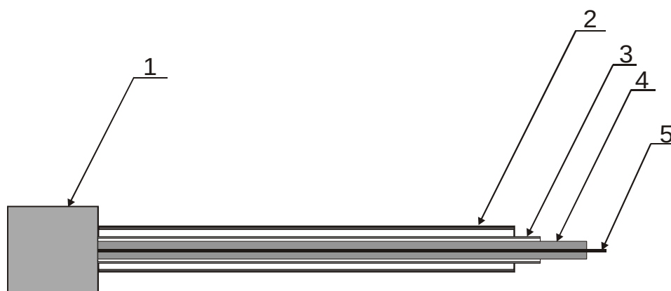
Рисунок 2. Схема иглы для СВЧ-термоабляции. 1 - СВЧ разъем, 2. защитный термозэкран из нержавеющей стали 3 - внешний электрод жесткого коаксиала, 4 - изолирующая керамическая трубка, 5 - центральный электрод жесткого коаксиала.
