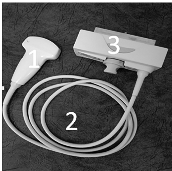
Рис. 18.4. Части датчика, подлежащие дезинфекции после обследования пациента с инфекцией COVID-19. 1 – сканирующая поверхность; 2 – кабель; 3 – коннектор
